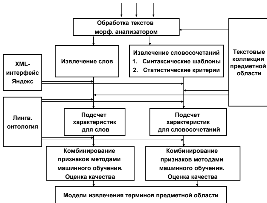
Рис. 8. Схема предложенного метода автоматического извлечения терминов. Лингвистические онтологии используются на двух этапах: как один из источников признаков и как средство для оценки качества извлечения
